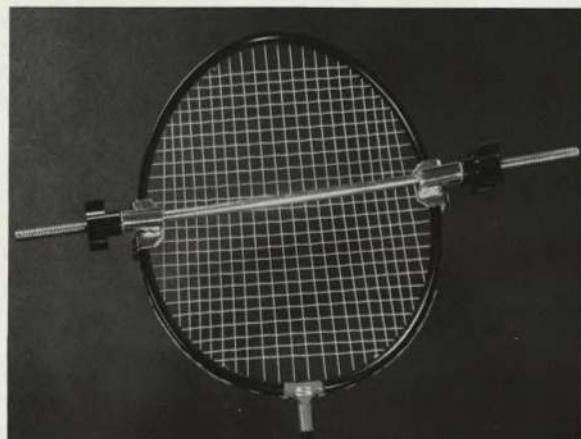
som är lätt att justera efter ramstorlek och kan användas i alla strängningsmaskiner.
